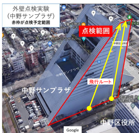
＜ドローンによる外壁点検範囲と2点係留装置の概略＞
